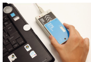
リーダー (別売) をパソコンにつないでロガーを置き、データを読み込みます。USBタイプの場合はお使いのパソコンにUSBケーブルで接続。
